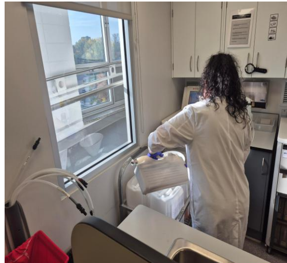
Photo 5: vidange manuelle des réservoirs de formol
