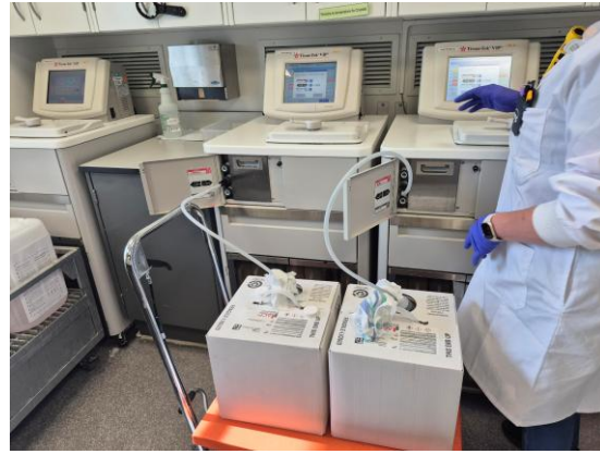
Photo 3: remplissage des circulateurs à la fin de l'entretien
